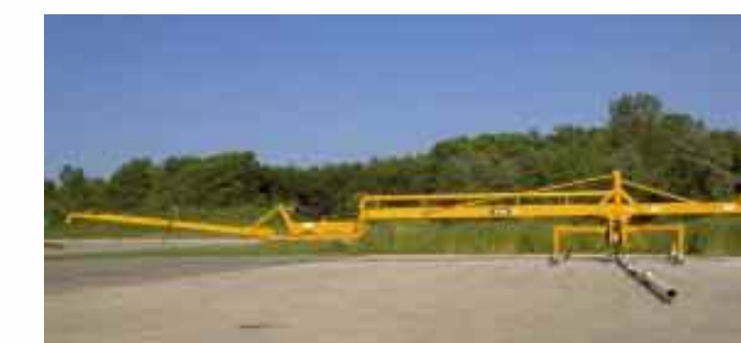
Mastro Separado com 3 funções de Controle: 1° Estágio: Rotação de 360° / 2° Estágio: Rotação / 3° Estágio: Movimentação Acima/Abaixo da última seção
