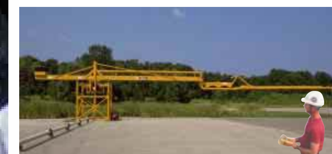
Mastro Separado com Torre Opcional e Estação de Controle com 3 Funções
