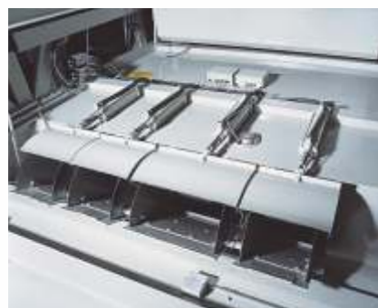
Comportas de dosagem
