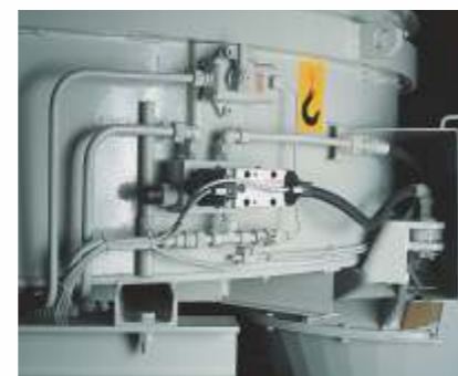
Descarga manual de emergência
